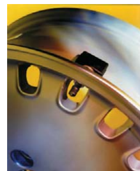
Рис. 1. Принцип крепления датчика на колесо
